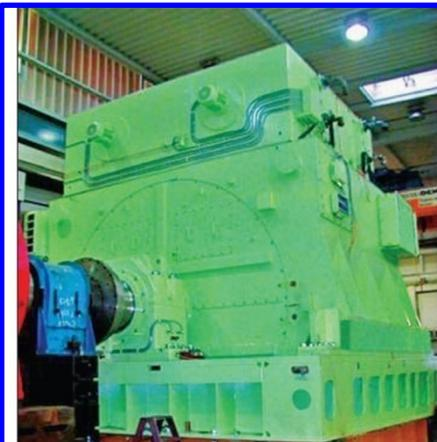
21MW 变速同步电机
