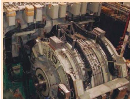
36.5MW 超导电机系统
